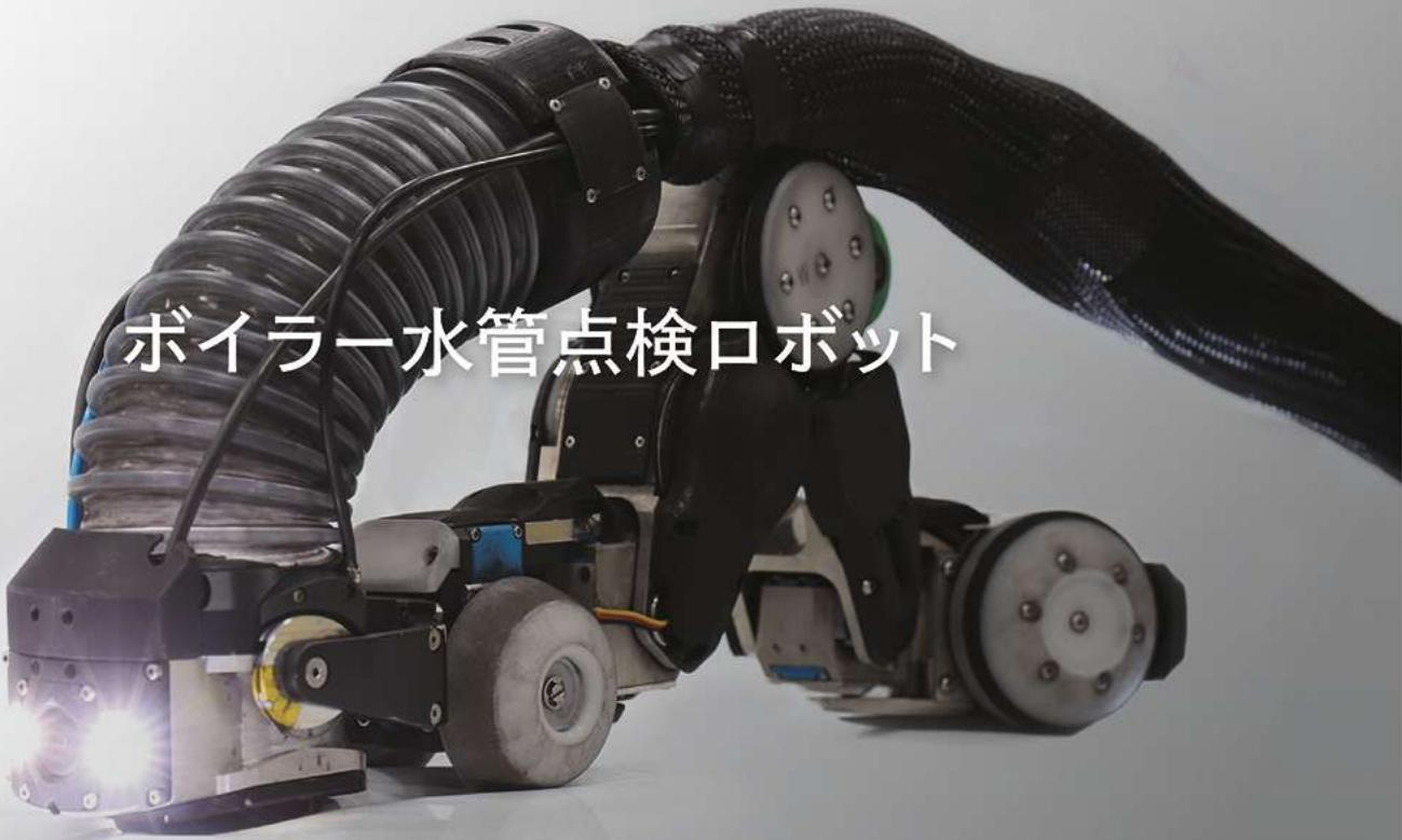
これは、ボイラ設備の点検作業を、「より早く、より安全に、より正確に」、行うために開発されたロボットです。
